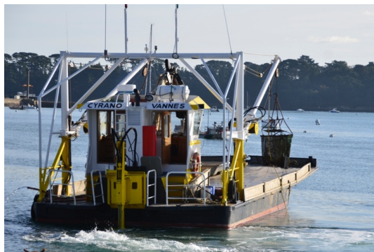
海底からドレッシで収穫できる作業船
